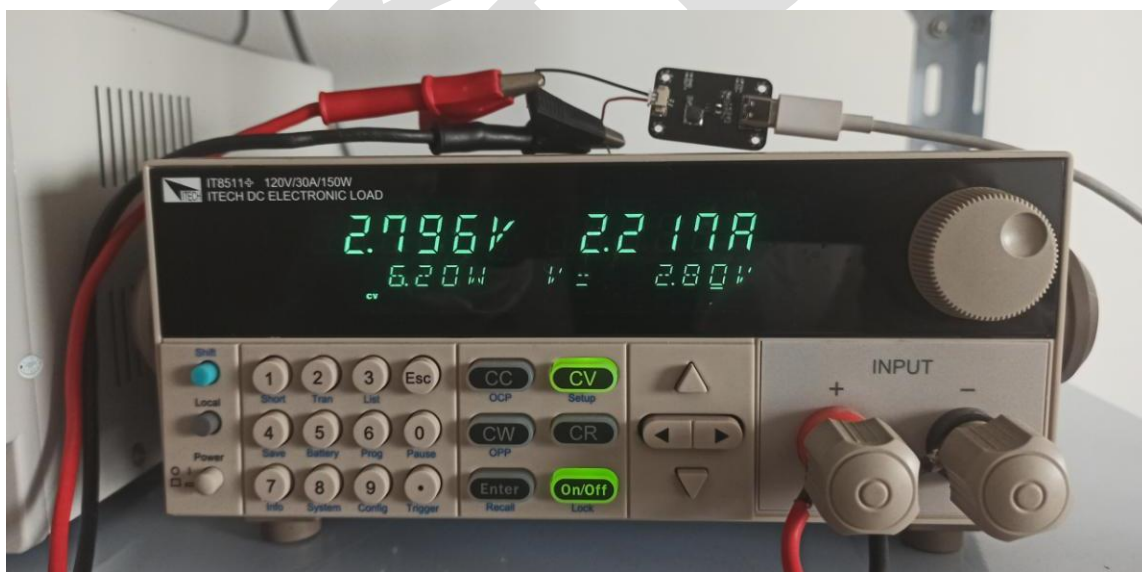
Figure9. 输出电压压降达到 0.2V 时的最大供电电流约为 2.2A
