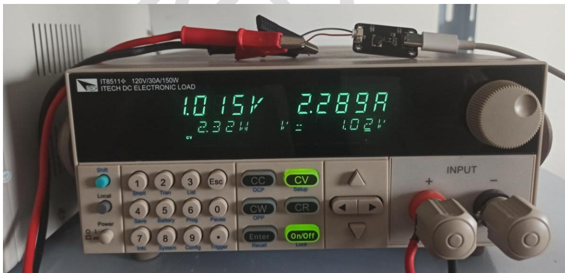
Figure5. 输出电压压降达到 0.2V 时的最大供电电流约为 2.3A
